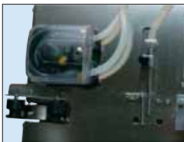
Bomba peristáltica de alto caudal para menor estrés del material seminal
