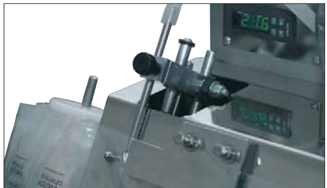
Control electrónico de temperatura de soldadura, temporizador de llenado e interruptor AUTOMÁTICO
