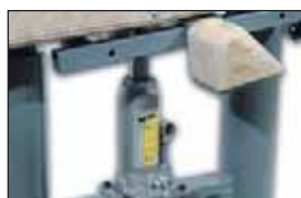
Sistema hidráulico para la regulación
